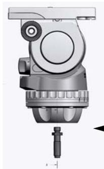
Um den FSB 6 mit Flachbodenanschluss verwenden zu können, muß der Gewindezapfen entfernt werden.
